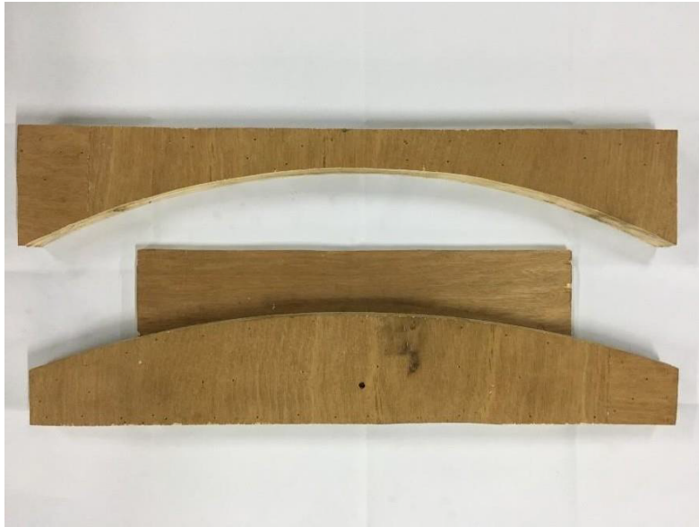
Gambar 5 Cetakan/mal Bending yang sudah dipotong (sumber: Ista Rizqi/21 November 2019/jam 01.06)
