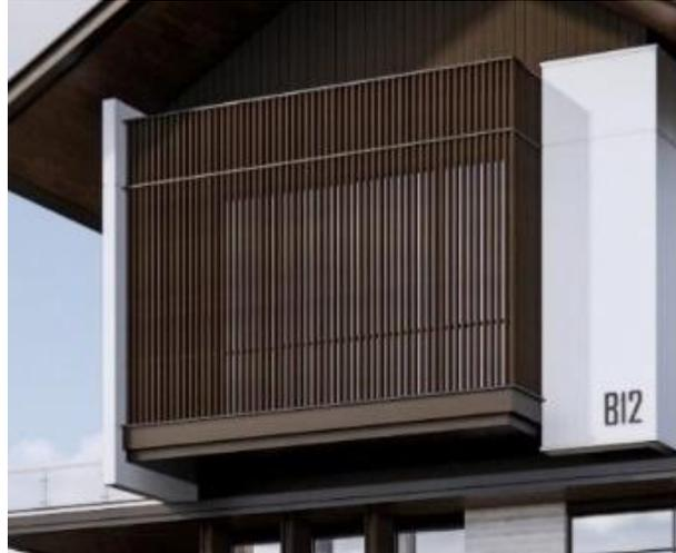
Gambar 5. Penerapan *Wood Panel Composite* (WPC) + Rangka Besi *Hollow* dan Plat Besi.
