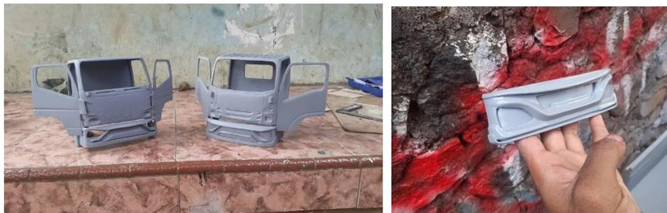
**Gambar 7.** Pori-pori kayu yang dilapisi dengan dempul untuk memberikan hasil yang baik dalam tahap pengecatan. Sumber :penulis
