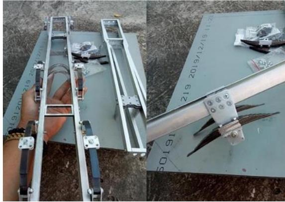
**Gambar 10.** Limbah besi yang dirakit menjadi bentuk rangka miniatur truk.
