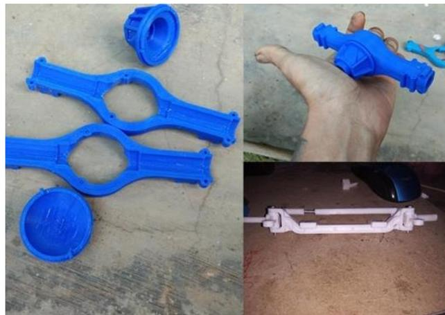
**Gambar 11.** Hasil pembuatan bagian *sparepart* dengan menggunakan Printer 3 Dimensi.
